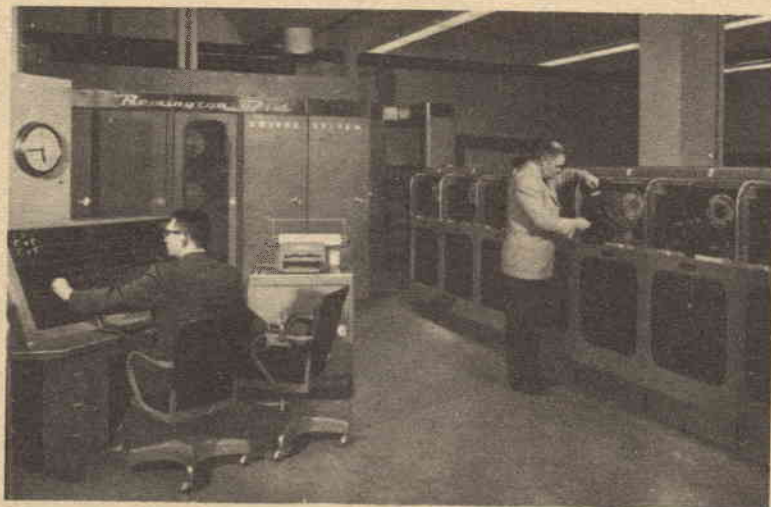
Una calcolatrice in azione. In fondo alla sala la sezione delle macchine contenente la memoria a mercurio
